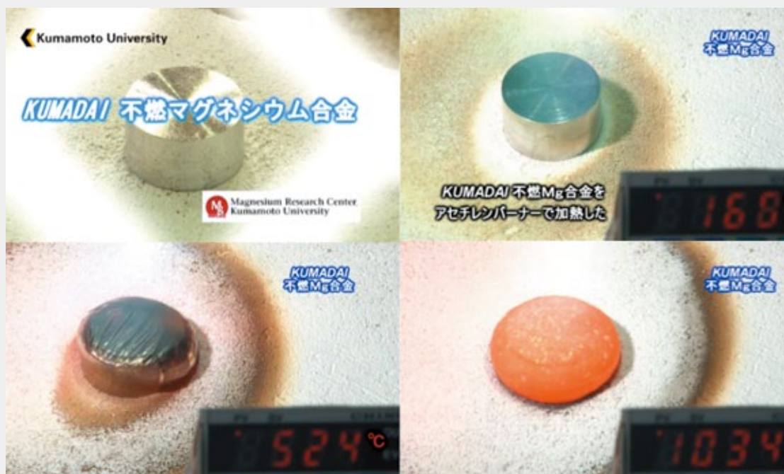
上 / KUMADAI 不燃合金をガスバーナーで炙った写真 (手前の数字は KUMADAI 不燃合金の温度)
