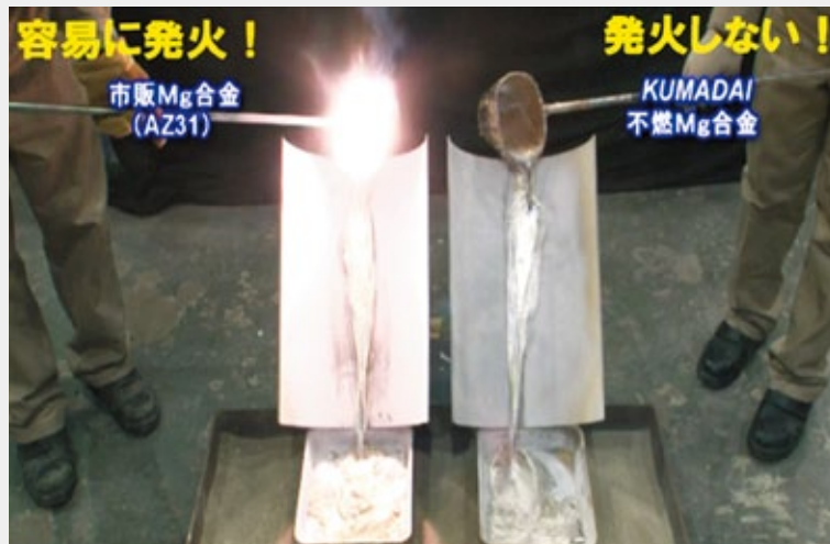
右／市販Mg合金とKUMADAI 不燃合金の比較 左／高性能マグネシウム合金創 成加工研究会の写真
