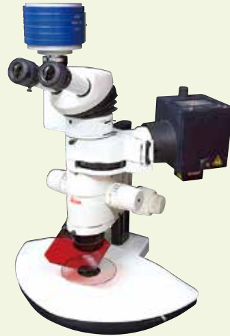
北野先生が使用している「実体蛍光顕微鏡システム」。 微小なものでも立体的に観察できる
