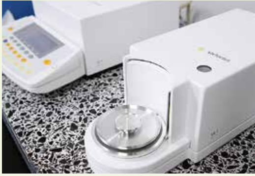
同位体の測定には電子てんびんを使用。同位体はアルミニウムカプセルに包んで試料皿に乗せる
