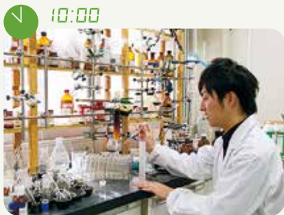
分子の流出速度(吸着力)の差を利用し、シリカゲルを使って化合物を分離精製する「シリカゲルカラムクロマトグラフィー」。
