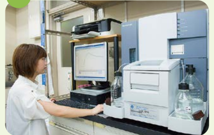
「SPRバイオセンサー」は分子と分子の結合を、質量の変化によってピコグラム単位で見ることができる。
