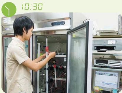
タンパク質がなくては始まらない!タンパク質を精製する「液体クロマトグラフィー装置」はほぼ毎日使う。
