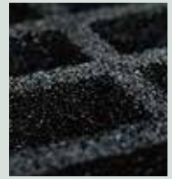
ゴム製品メーカーと共同研究したゴム製床材。ゴムの粒子を数ミリ単位でブロック状に固めた多孔質な構造により吸音。
