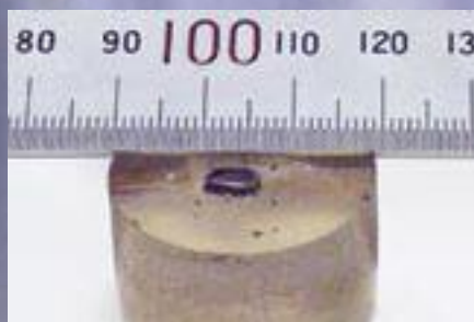
高性能爆薬の爆発衝撃力で作った5ミリ強のダイヤモンド粒
