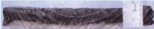
A:ホウ砂(不燃剤)を注入した木材を加熱して1時間経過したもの
