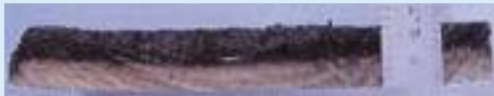
B:ホウ砂・ケイ素(不燃剤)を注入した木材を加熱して1時間経過したもの
