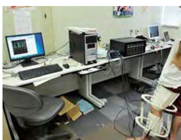
膝の動きを6方向に分けて数値化する「6自由度膝動態計測システム」。患者の症状を数値化することで確定診断に役立つ。すでに熊本大学医学部附属病院にて実用化
