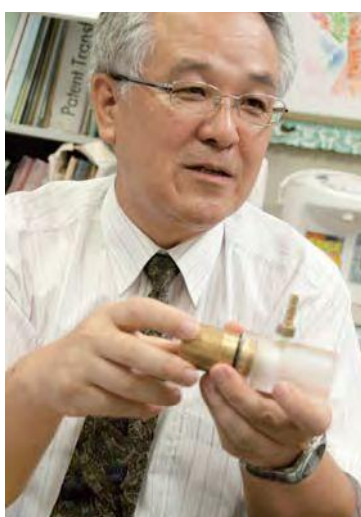
マイクロバブルやミスト等を作る「多流体混合器」は手のひらサイズだが、その力は大きい
