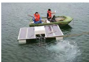
海に浮かべたフィルム状太陽電池（富士電機システムズ製）を電源として水質浄化装置を始動。マイクロバブルが湧きあがった瞬間、周囲から歓声が上がった＝上天草市松島で撮影
