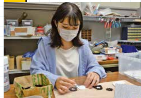
ヤスリを使って 手作業で磨き、 専用接着剤で パーツなどを 付けます
