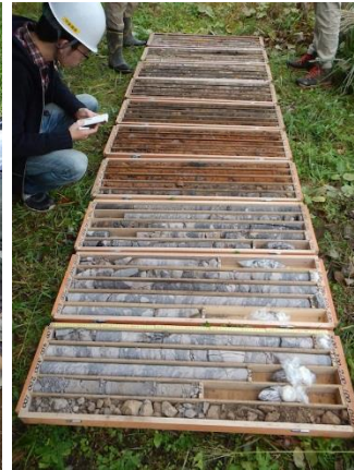
ボーリング調査 (西原村大峰火山)
