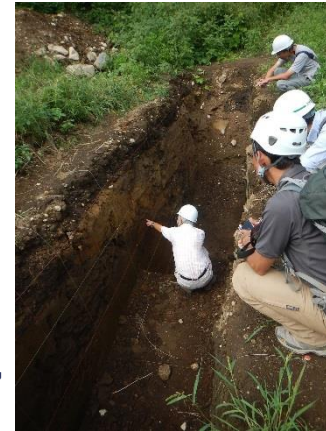
活断層トレンチ調査 (西原村大切畑ダム)
