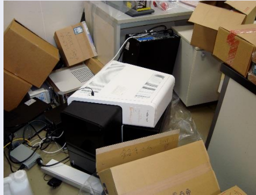
デスクトップ型次世代シーケンサーとそのサーバーが実験台から落下
