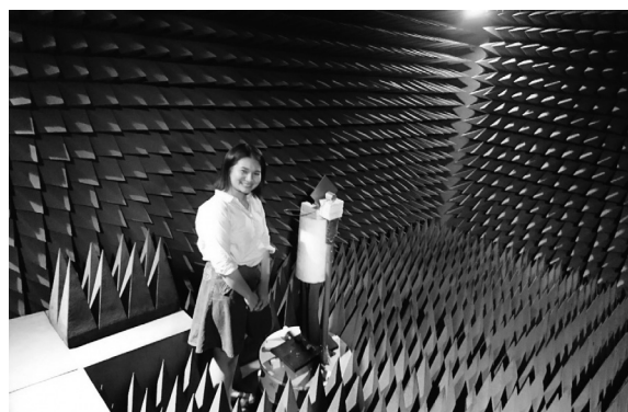
図6 電波暗室におけるメタ表面からの放射特性の特性
